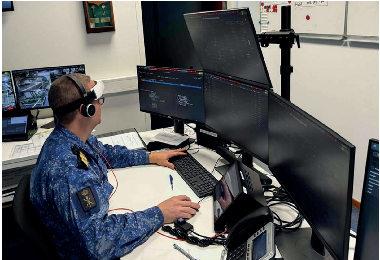
Voorbeeld van een fNIRS-headset die de zuurstofverzadiging in de prefrontale cortex meet. De real-time data wordt direct doorgestuurd naar een datalogger (laptop)
