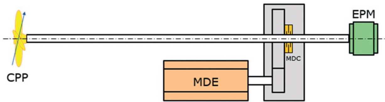
Figuur 1: voortstuwing van conceptueel fregat; een van de twee schroefassen is afgebeeld
