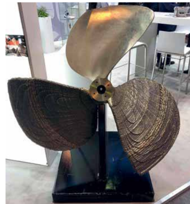
Een door RAMLAB voor Damen geprinte schoepsschroef die onder een sleepboot in de haven van Rotterdam is gebruikt (RAMLAB)
