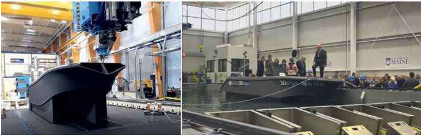
Een 3D-geprinte boot (University of Maine, USA, 2019)
