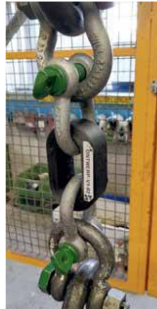
Vooruitgang en performance: kunststof geprinte hijsschalm tilt 12 ton YPR-pantserwagen
