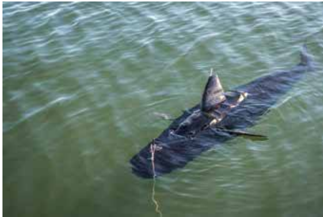
Een van de zee-drones die nu worden getest, de Ghostswimmer; een 3 meter lang haaivormig vaartuig dat beweegt als een vis. (foto Edward Guttierrez/US Navy)
