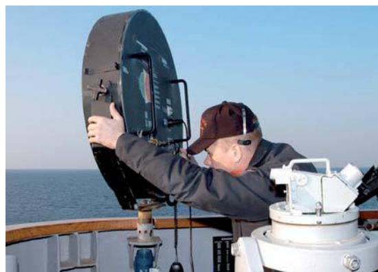
Een Long Range Acoustic Device, dat over grote afstand een zeer geconcentreerd (luid) geluid kan overbrengen.
