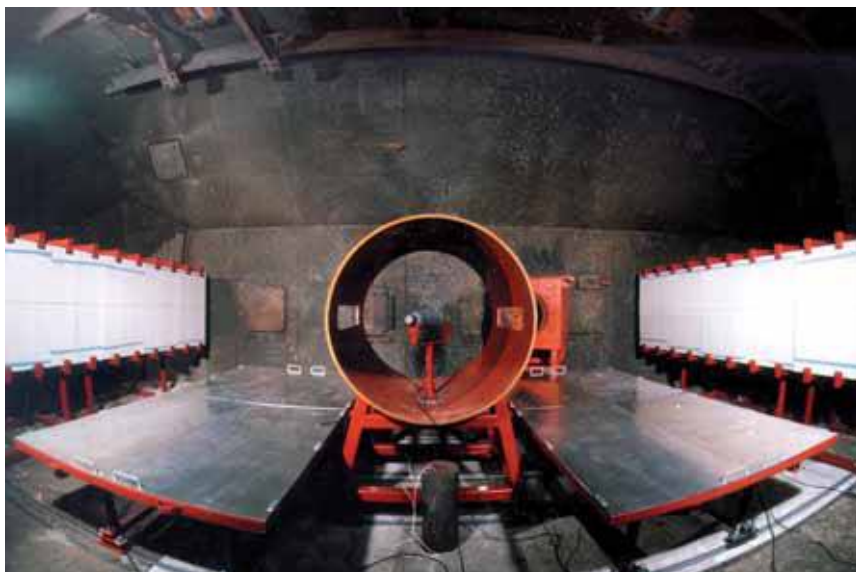
Afb. 5: Opstelling bij TNO om verscherving van de warhead te evalueren.
