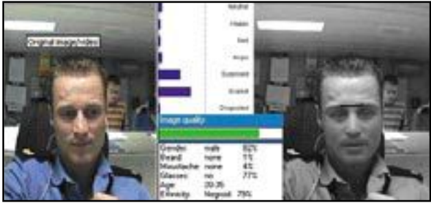
Figuur 4: Automatische emotiedetectie aan de hand van gezichtsuitdrukkingen, links het originele beeld, rechts een classificatie "masker" over het gelaat gepresenteerd. (www.noldus.com)
